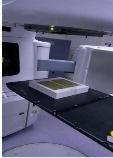
Şekil 57. Kolimatör ve Masa Dönüşü Film Işınlaması Set-up Görseli
