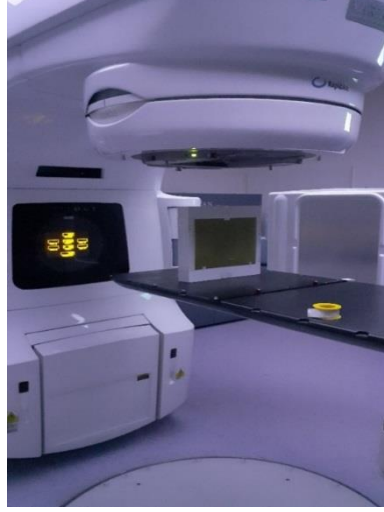
Şekil 58. Gantry Dönüşü Film Işınlaması Set-up Görşeli
