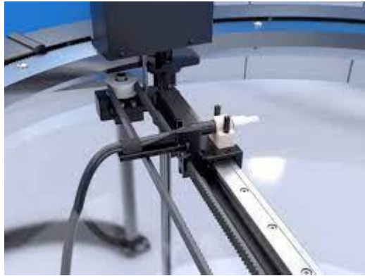
Şekil 24. SNC Marka Su Fantomu İçerisine Yerleştirilmiş İyon Odası
