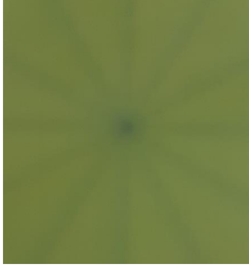
Şekil 59. Kolimatör, Masa ve Gantri Dönüşü Işınlaması Film Sonucu
