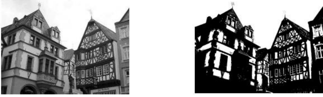
Şekil 3.12: Örnek Görüntü ve OTSU Algoritması Uygulanmış Hali
