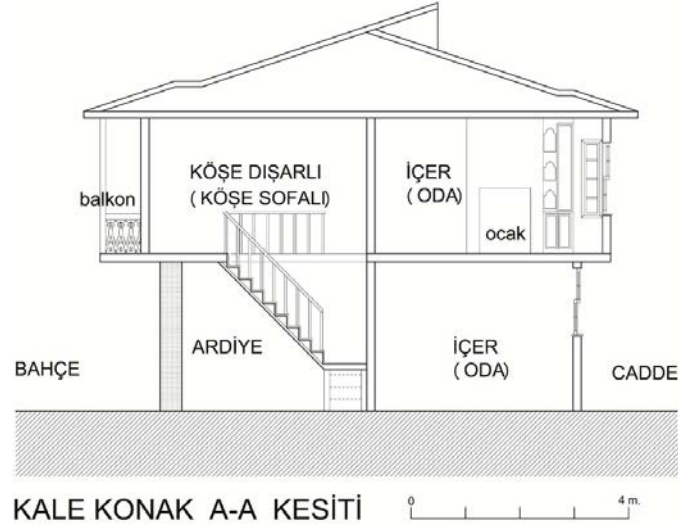
Şekil 3.24: Köşe sofalı plan tipinden sofanın (dışar) arka bahçe tarafında yer aldığı kesit örneği
