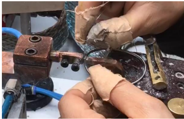
Şekil 4-3: Çerçeve-Boru Kaynak İşlemi
