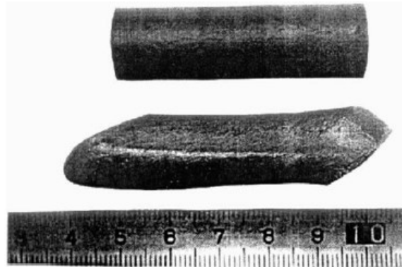
Şekil 3.8 : EKAP tarafından işlenmeden önce ve işlendikten sonra saf tungsten numunelerinin görünüşü [14]
