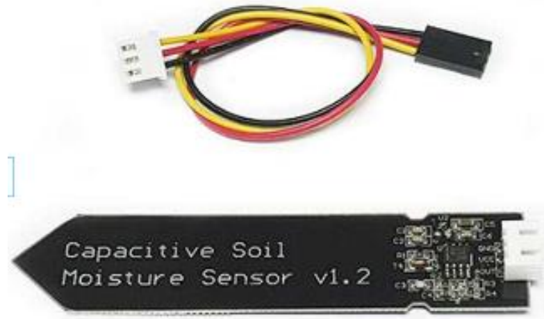
Şekil 16. Toprak nem sensörü görseli
