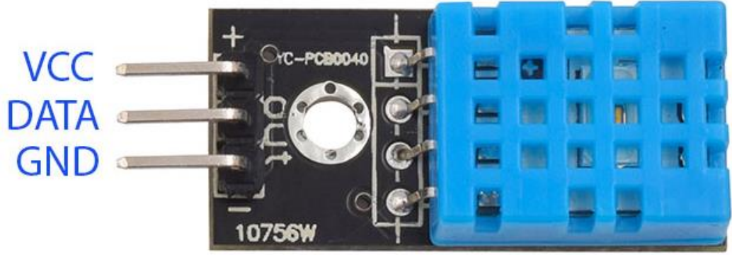
řekil 13. DHT11 Pin ıkıřları
